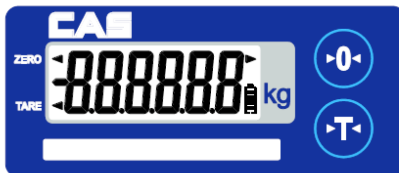
Рисунок 4.1 – Вид передней панели и дисплея весов PDC
