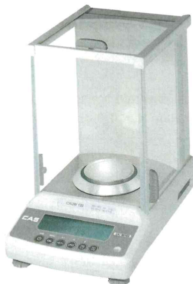
Рисунок 1 – Общий вид весов CAU
